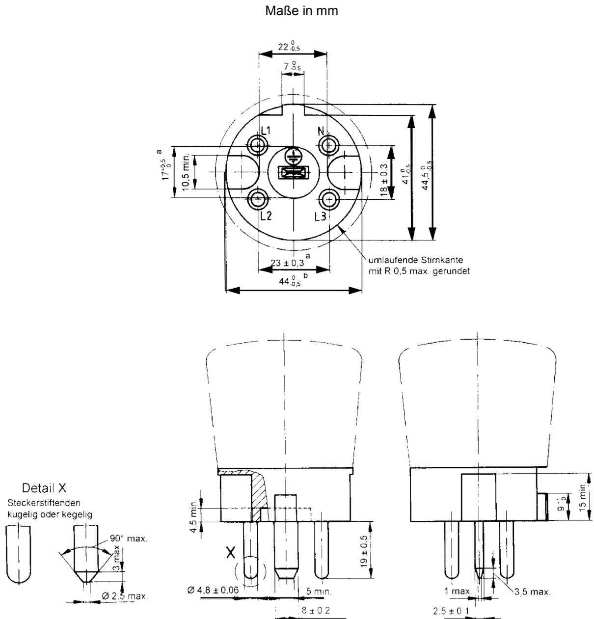
**Bild 1 – Dreipoliger Stecker mit N- und Schutzkontakt**
