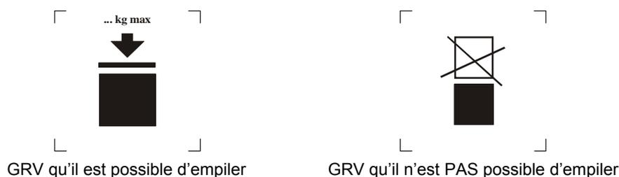
Le pictogramme ne doit pas avoir des dimensions inférieures à 100 mm × 100 mm ; il doit être durable et bien visible. Les lettres et les chiffres indiquant la masse admissible doivent faire au moins 12 mm de haut.
