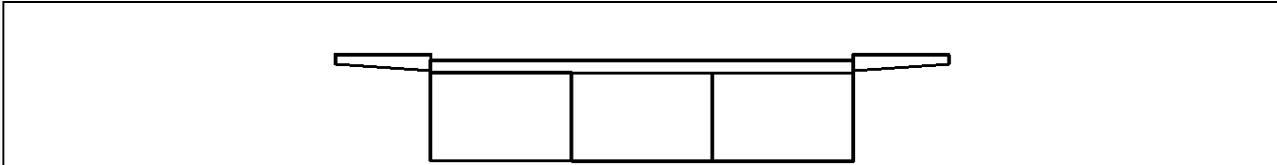
Abb. 1 Geschlossener Querschnitt einer Brücke (schematisch)
