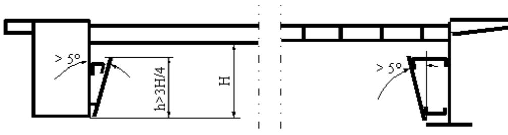
Abb. 5 Querschnitt einer Brücke (schematisch) mit Schrägeinbauten
